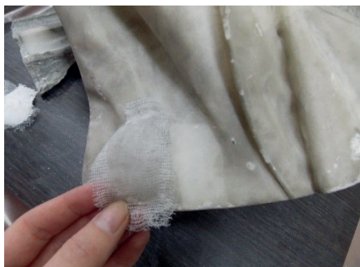
23. Wynik oczyszczenia za pomocą kleju PVA z gliceryną (10%) Result of cleaning with polyvinyl acetate adhesive with glycerine 10%
