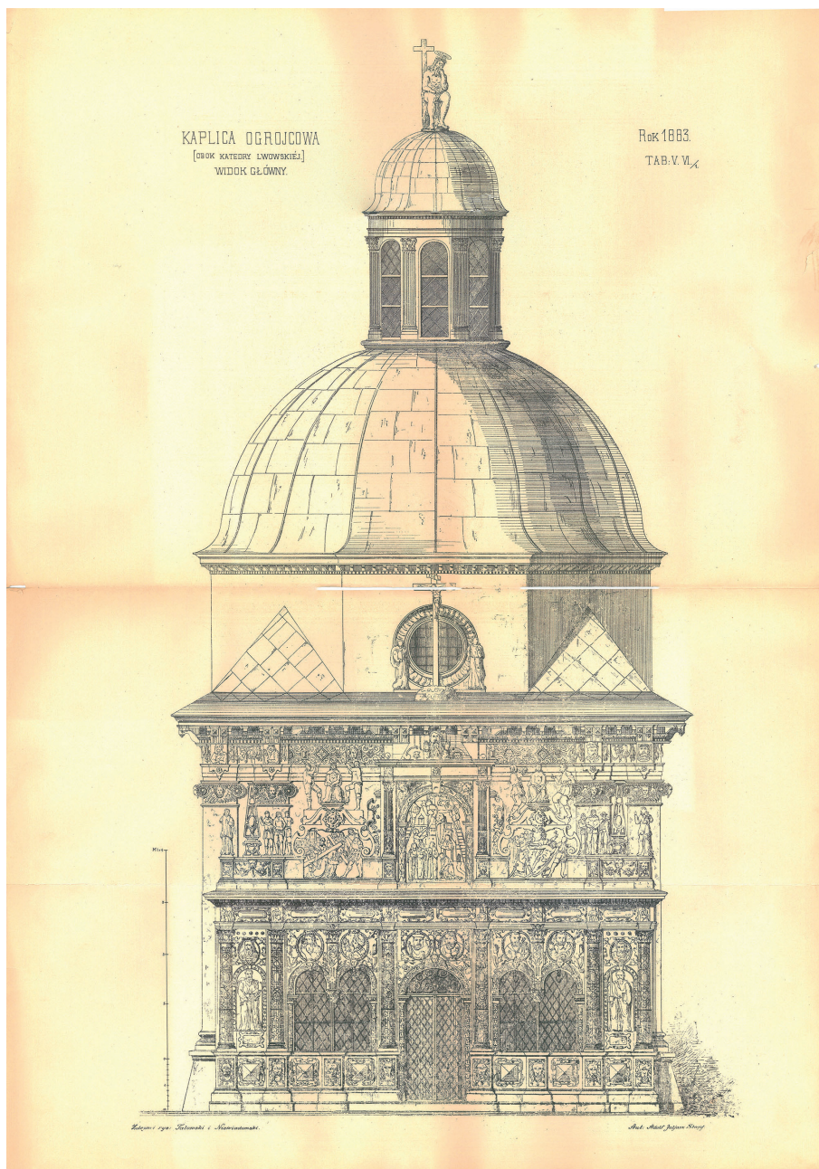
Il. 3, 4. Rysunek elewacji i kopuła kaplicy Boimów we Lwowie. Przeprowadził pomiary i rysował S. Bieńkowski, pod kierunkiem Janusza Sas Zubrzyckiego.
