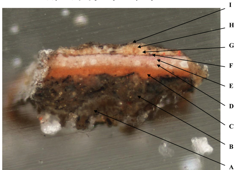
Il. 19.2. przekrój stratygraficzny próbki pobranej z partii burki Leo Tyszkiewicza; pomiędzy oryginalną warstwą koloru burki (E) a warstwą przemalowania (G) jest cieniutka warstwa brudu (F).
