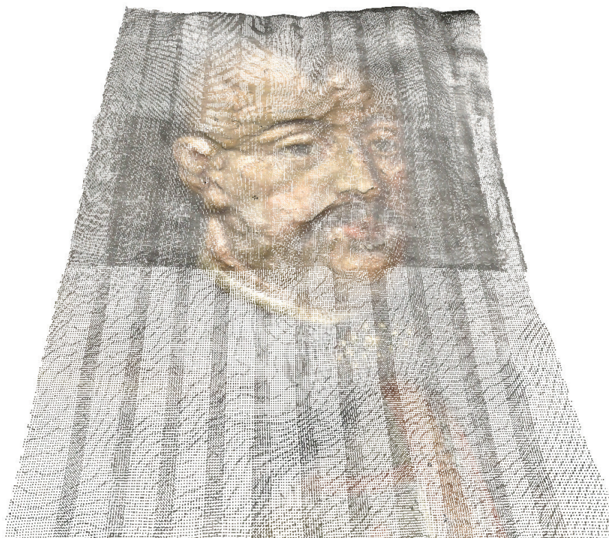
Il. 5. Skan części centralnej portretu. Widoczny sposób złożenie większego obszaru z poszczególnych pionowych pasów uzyskanych w wyniku skanowania.
