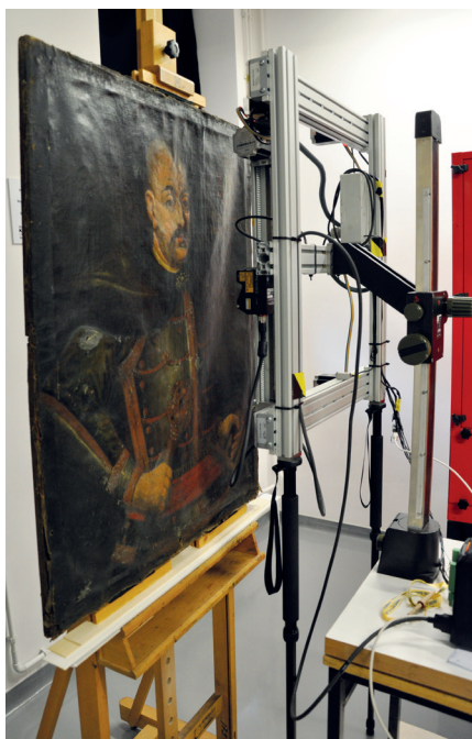
Il. 3. Prototypowy model skanera laserowego 3D, stanowisko badawcze. Fot. A. Rzeszutek.
