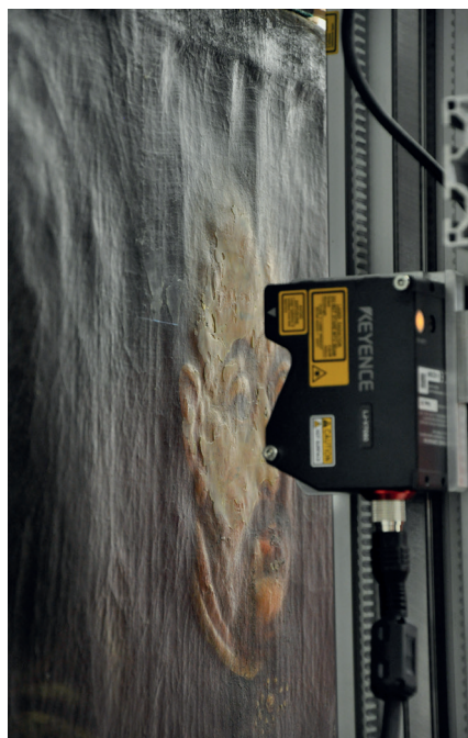
Il. 4. Głowica laserowa firmy Keyence w trakcie skanowania powierzchni obrazu. Fot. A. Rzeszutek.
